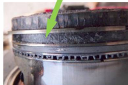
ピストンリング周りに堆積したスラッジ
